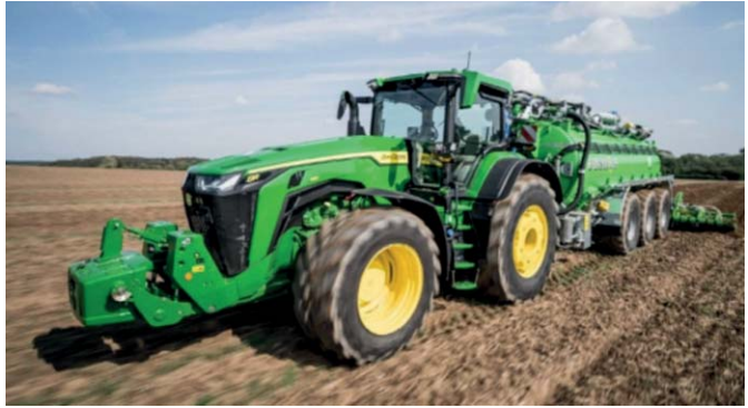
Transmissão eAutoPowr da John Deere série 8R com acionamento elétrico para o caminhão-tanque Joskin.
