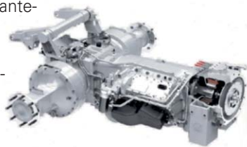
Transmissões CVT da ZF.Izq. Hidromecânica. Direito Eletromecânica.
